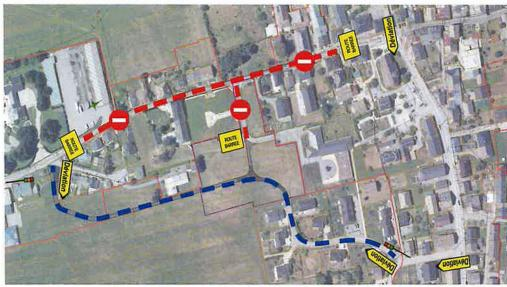
RD911 barrée, piste de déviation accessible aux VÉHICULES LÉGERS, DE SECOURS, SERVICES PUBLIQUES ET INTERDIT AUX VÉHICULES SUPÉRIEURS À 19 T ET À SUPÉRIEURS À 12 M DE LONG.
